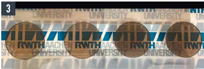
Bild 3 • Makroaufnahmen ausgewählter polierter Proben nach Sinterung (1700 °C) und HIP (1650 °C), Dicke d = 2,0\text{--}2,2 mm, Abstand zur Blattoberfläche: 10 mm
