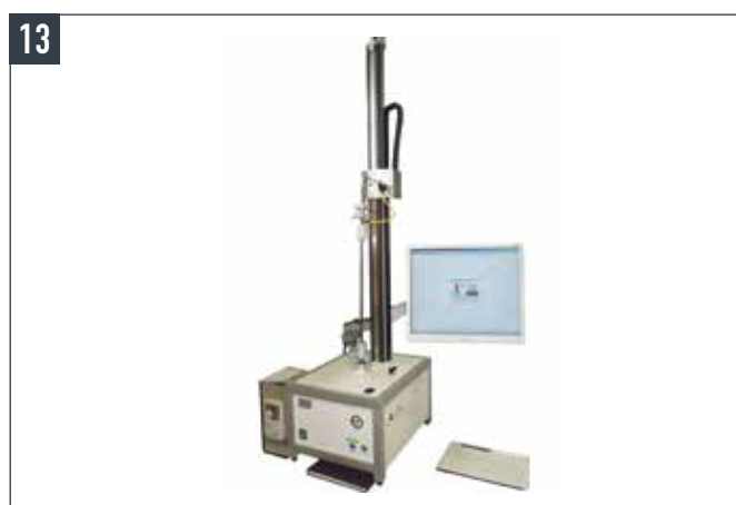
Bild 13 • Testapparatur zur Bestimmung der Leckagerate von Membranen
